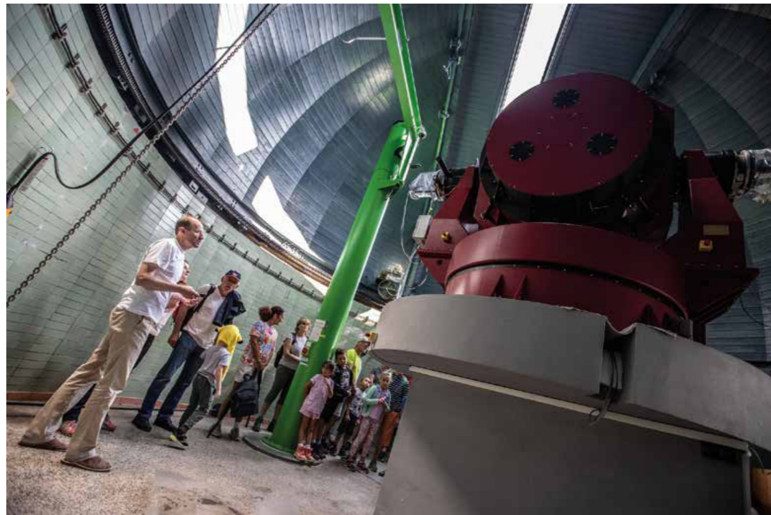
Vo veľkej kupole Astronomického observatória na Skalnatom Plese sa nachádza 1,3 m ďalekohľad typu Nasmyth-Cassegrain. Využíva sa na pozorovanie objektov slnečnej sústavy aj stelárnych objektov.
