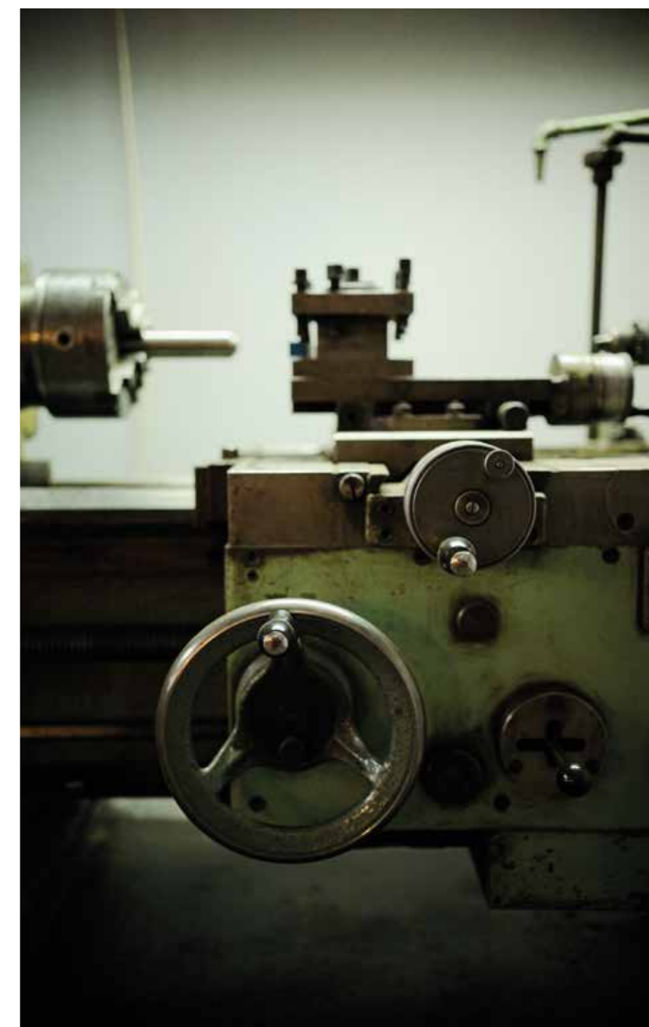
Detail na nožovú hlavu a ovládanie priečného a pozdĺžneho ručného posunu na sústruhu SU 32.
