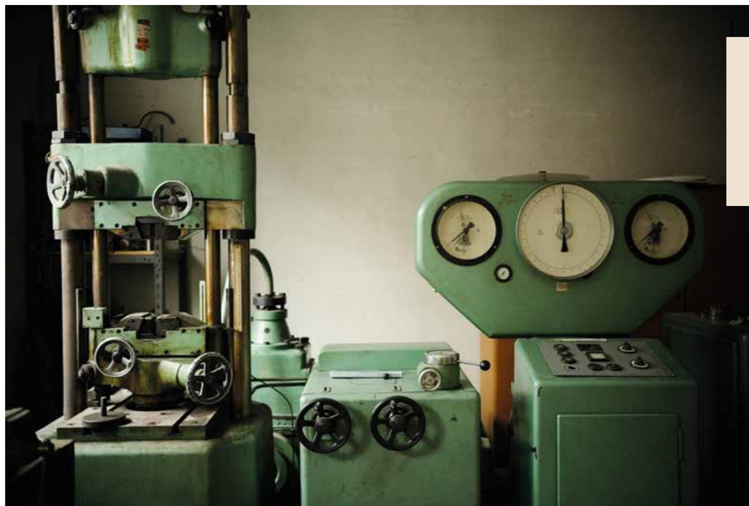
Najmenší skúšobný stroj ZDM 10 Pu. Využíval sa napríklad na testovanie únosnosti a pevnosti betonárskej výstuže alebo zvarov výstuže. Vľavo je telo samotého stroja, v strede blok s hydraulickými čerpadlami a napravo elektrické ovládanie, selénový usmerňovač a zobrazovače sily. V pozadí je aj malý pulzátor.
