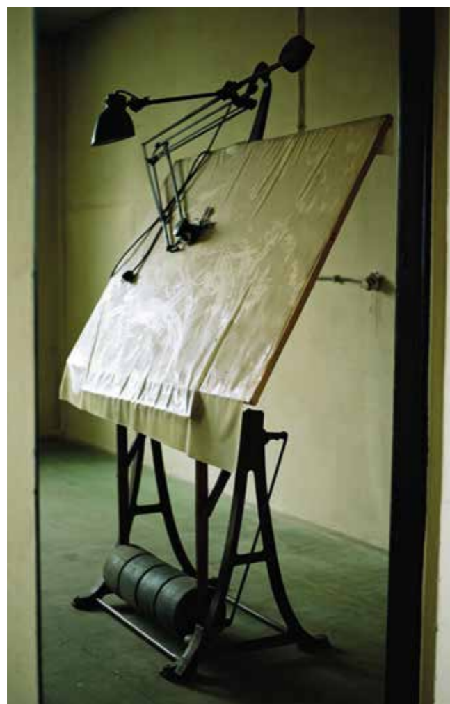
Rysovacia doska (pantograf), kde vznikali návrhy vzoriek určených na skúšku, prípadne prípravky na upínanie vzoriek pre skúšobné stroje, ktoré boli následne vyrábané v dielňach.
