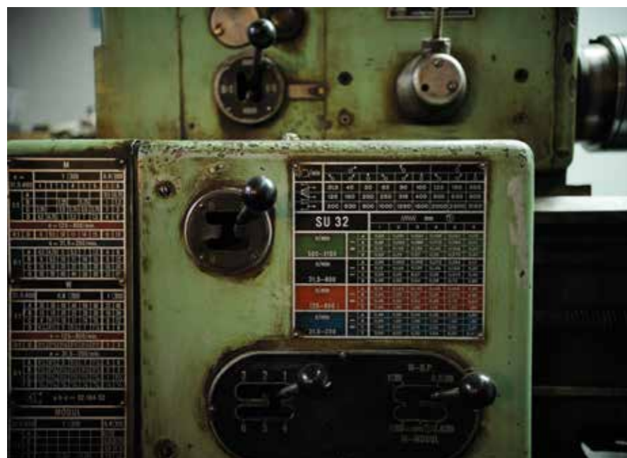
Prevodová tabuľka na sústruhu SU 32, ktorý slúžil na úpravu testovaných oceľových vzoriek.
